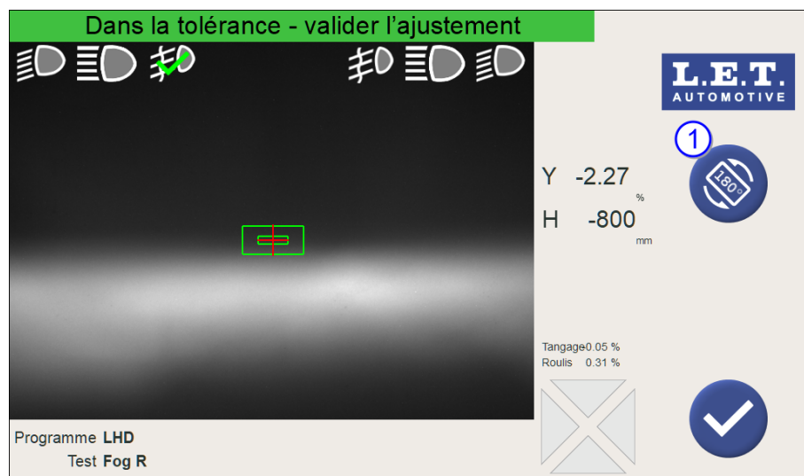
Illustration 15 : Mesure du faisceau antibrouillard
